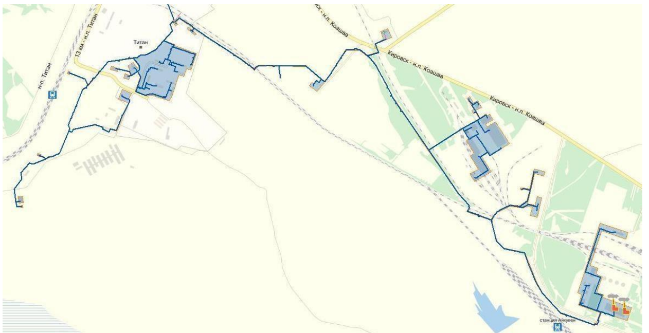
Рисунок 11.4.7 - Зона теплоснабжения от котельной АНОФ-3
