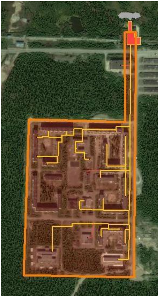
Рисунок 11.4.8 Зона теплоснабжения электрической БМК н.п. Коашва
